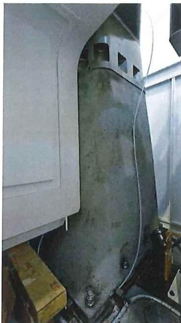
Particolare della Arion con struttura in ghisa
