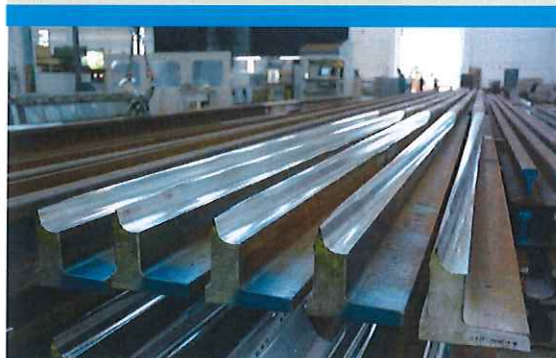
Particolare della lavorazione degli «aghi» che rappresentano il cuore del gruppo scambio per binari ad alta velocità
