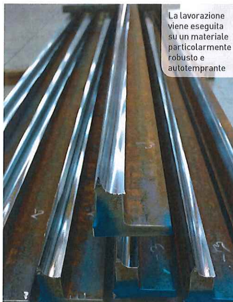
Particolare della lavorazione degli «aghi» che rappresentano il cuore del gruppo scambio per binari ad alta velocità
