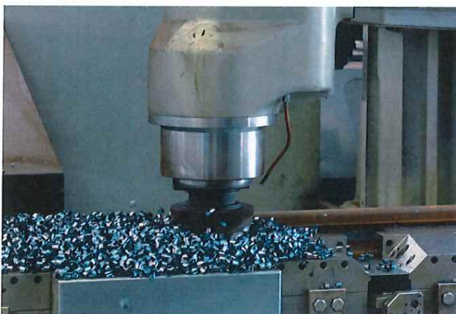
La potenza di ben 74 Kw della testa a uscita diretta permette una grande asportazione di truciolo
