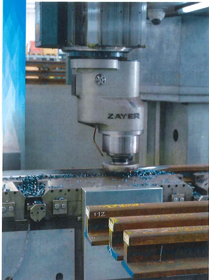
La macchina utilizza in questo caso una fresa da 350 mm del peso di oltre 140 Kg
